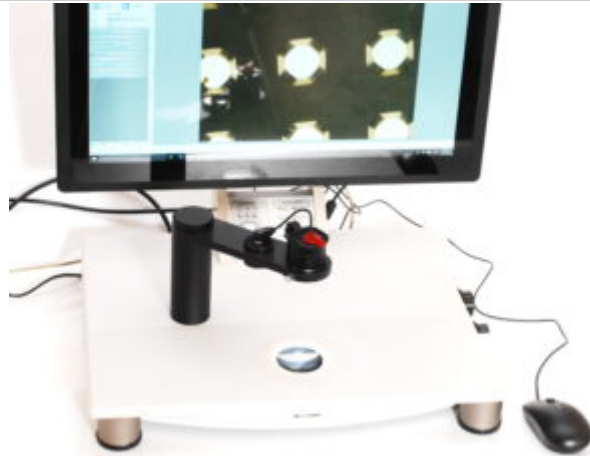
Общий вид, перфорированная пластина — кремний на предметном столе
