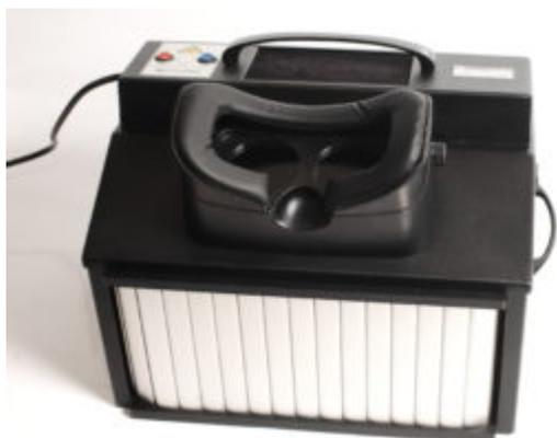
Безопасность зрения лаборанта обеспечивается как используемым защитным УФ-фильтром, который установлен перед окуляром, так и гораздо более редкой необходимостью наблюдать образец визуально: его прекрасно видно на экране дисплея или компьютерного монитора. УФ-осветитель к аналитическому кабинету снабжен специальными светоизлучающими мощными диодами и спектрально-селективными фильтрами (фиолетовое стекло). УФК-HD оснащен сдвижной шторкой
