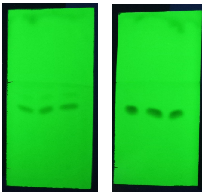
Рис. 1,2 – пятна чистых веществ (цифлутрина и эсбиотрина) на хроматографических пластинах.
